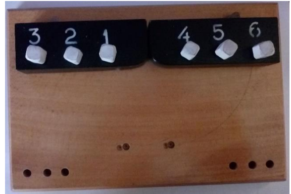
Εικόνα 21: Το άνοιγμα του κελιού και η αντιστοίχιση με τα πλήκτρα της γραφομηχανής
