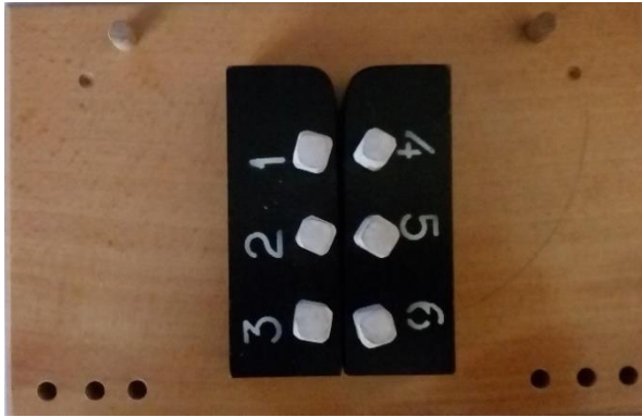
Εικόνα 21: Το άνοιγμα του κελιού και η αντιστοίχιση με τα πλήκτρα της γραφομηχανής
